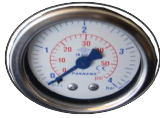
ALÇAK BASINÇ SAATİ Sayesinde Deniz Suyu Kesintileri Takip Edilir.
