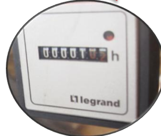
Cihazın Çalışma Zamanı ve Bakım Sürelerinin Hesabı ZAMAN SAATİ Sayacıyla Yapılır.
