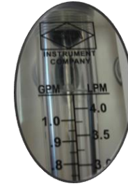
DEBİMETRE Üretilen Tatlı Suyun Miktarını Litre / Dakika Olarak Gösterir.
